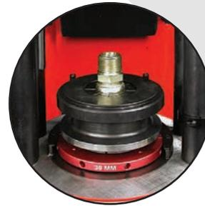
**HIGH VISIBILITY:** INVERTED DIE POSITION ALLOWS OPERATOR TO ACCURATELY POSITION THE FITTING PRIOR TO CRIMPING.
